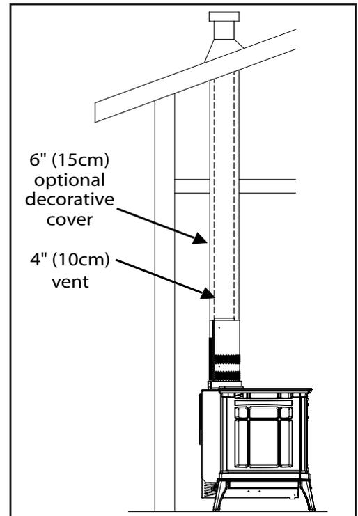
Figure 46: B-Vent Setup
