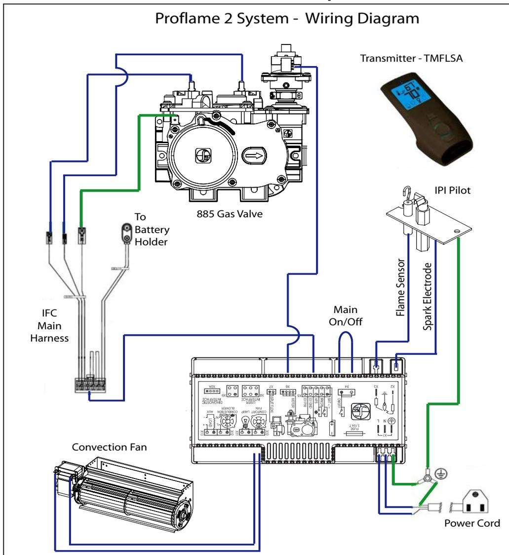
**Figure 44: Wiring Diagram**
